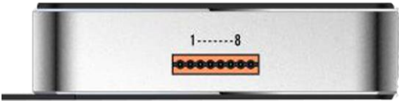
图 5.1.1 UR4 GPIO 端子位置
